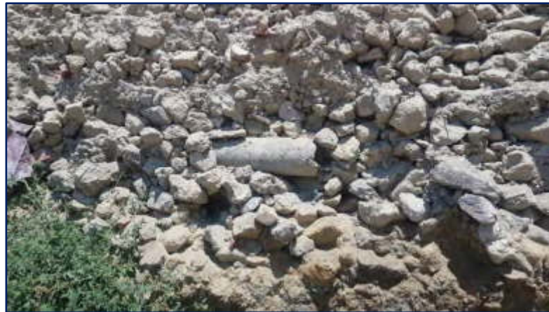
Figura 3: frammenti di tubazioni in Fibrocemento incastonati nella nicchia di erosione al piede della conoide
